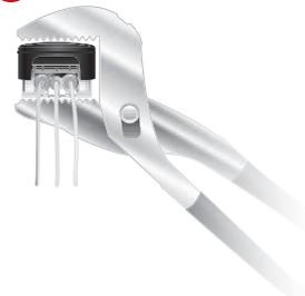
Werkzeug rechtwinklig zu den Leitern in der Mitte der Kappe ansetzen. Kappe niederdrücken, so dass die Seiten der Kappe bündig zur Unterkante des Verbinders sind und mit einem hörbaren »Klick« einrasten.
